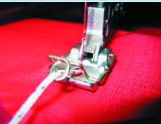
Spezieller Saumfuß, um Schnüre aufzunähen: erleichtert die Arbeit ungemein
