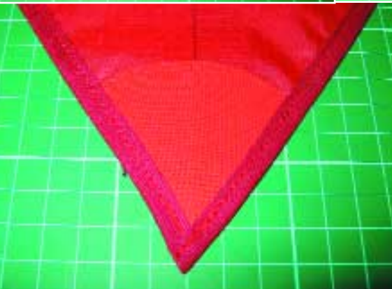
Gesäumter Drachen im Verstärkungsbereich, oben die auf das Dacron genähten Laschen
